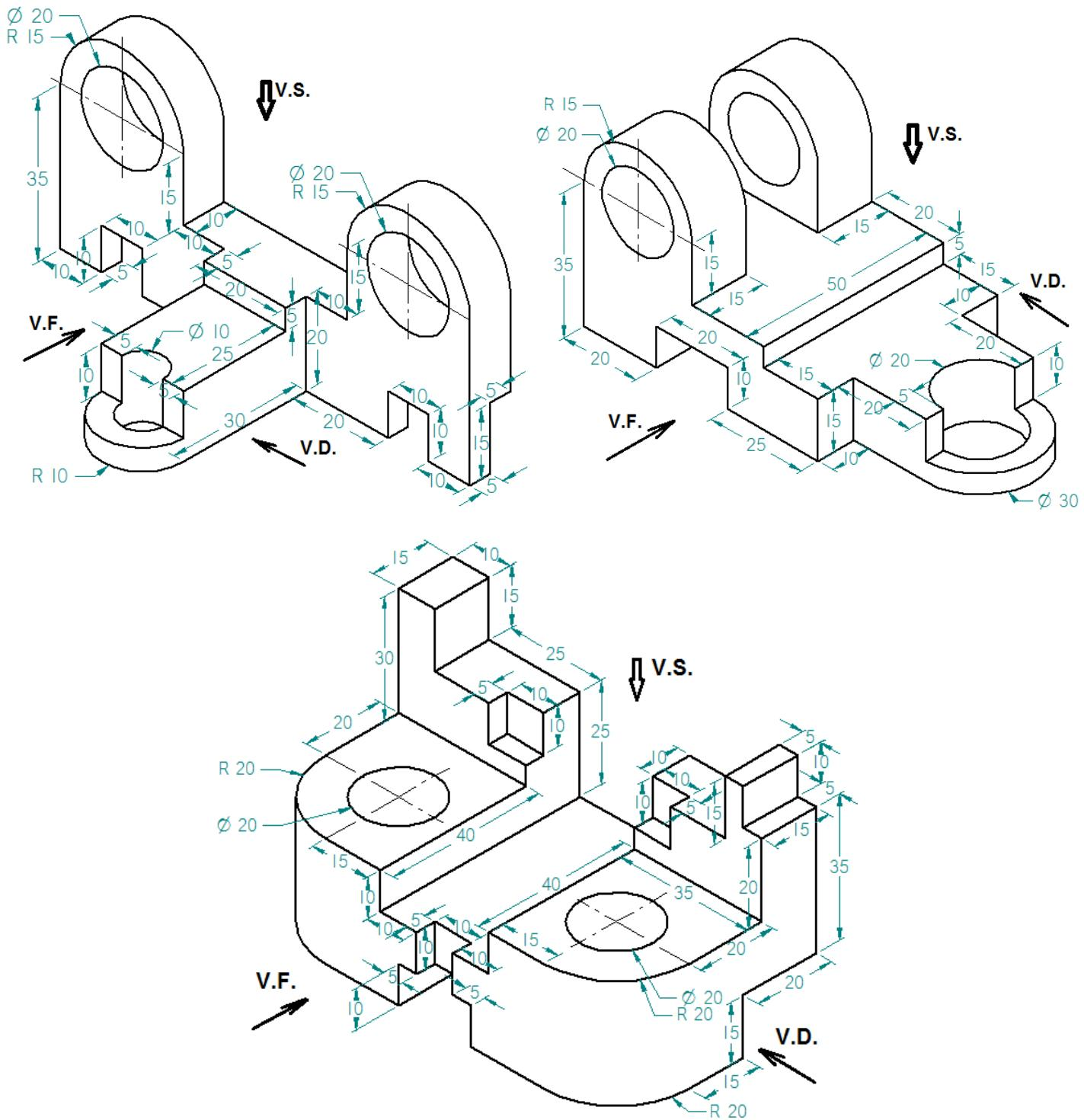
**Actividad 2:** complete a mano alzada las vistas frontal, superior y lateral derecha del isométrico adjunto. No hay que medir. Dibuje en forma proporcional.
