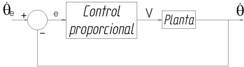
La función de transferencia total para el lazo cerrado puede ser expresada como habíamos visto en la Ecuación 1, siendo  $P(s)$  la función de transferencia del control proporcional. Se utilizará una función de transferencia para la señal de realimentación igual a 1:
